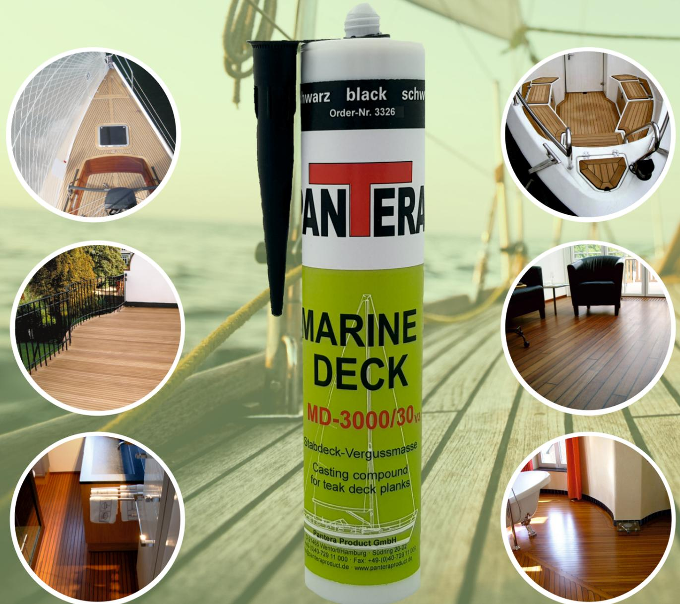
Marine Deck MD-3000/30 V3 wurde speziell entwickelt, um eine silikonfreie, dauerhafte, elastische und hochdehnbare Stabdeckfugenmasse für Holzdecks anzubieten. Durch die geringe Shore A Härte von ca. 33 und einer Bruchdehnung von ca. 550 % baut MD-3000/30 V3 die, durch Trocknung und Anfeuchtung des Holzes, entstehenden Spannungen in der Dichtfuge sicher und schnell ab.
